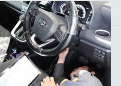
スキャンツールという装置を使います。車検証に記載された二次元コードやICチップを読み込んで車両のコネクターにスキャンツールを接続すると不具合を検出できます！
